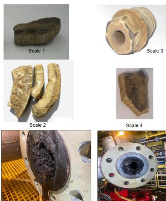
Hình 1: Lắng đọng \text{CaCO}_3 lẫn paraffin trong hệ thống khai thác dầu khí
