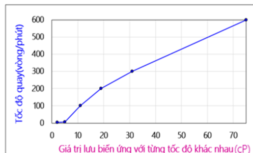
Hình 4. Thông số lưu biến của hệ vật liệu ứng với các tốc độ vòng quay khác nhau tại 85 °C
