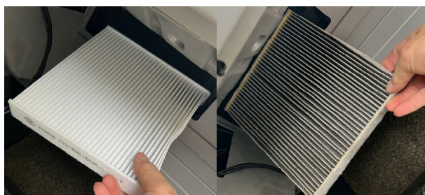
Hình 2. Tấm lọc gió chưa mang và có mang graphene
