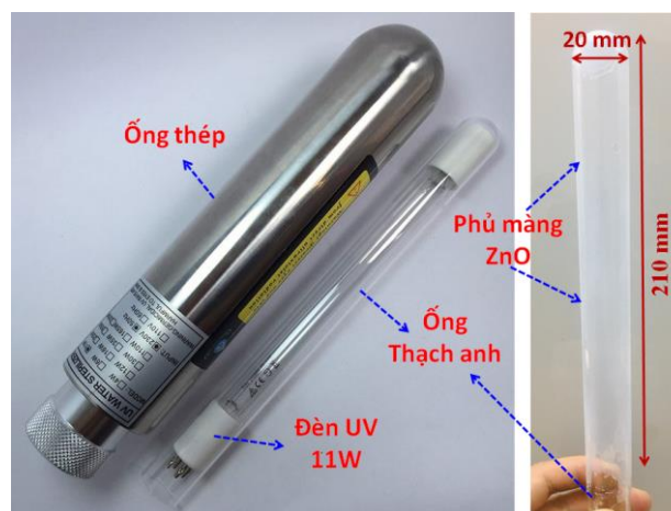
Hình 1: Ống thạch anh của đèn UV trước và sau khi tạo màng
