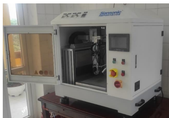
Hình 1: Thiết bị phun siêu âm Siansonic UC330 tại Viện Khoa học vật liệu
