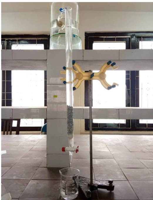
Hình 2: Sơ đồ cột hấp phụ
