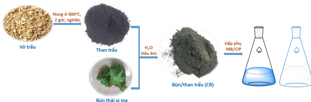
Hình 1: Sơ đồ chế tạo vật liệu hấp phụ (CR) từ bùn thải xi mạ và than trấu
